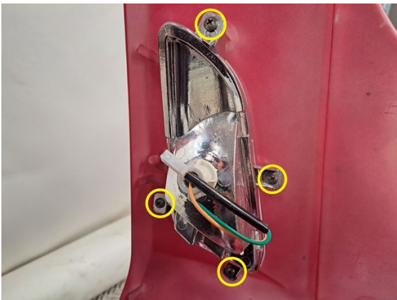
irrota vasemman etuvilkun kiinnitysruuvit. (ristipäämeisseli ph2).
